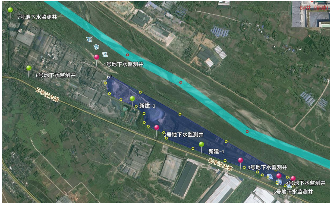
图1 堆体地下水监测井布设 表1 地下水采样点布设
